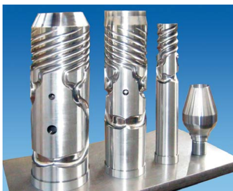
Wendelverteilerhülsen für dünnwandige Coex-Behälter Farbpigmenten auf die äußere Schicht reduziert wurde.
