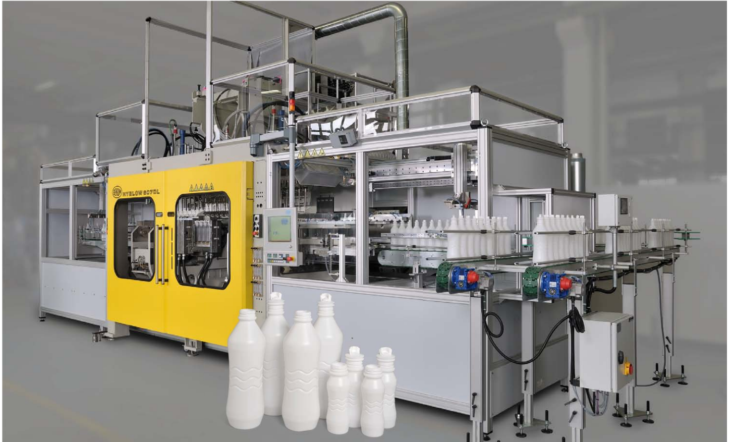
HYBLOW 607 DL für die 9-fach Produktion von 1000 ml Verpackungen mit Produktionsbeispielen
