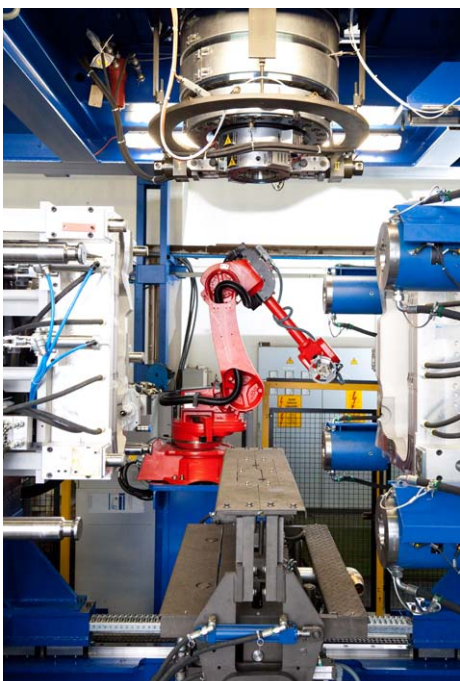
Unidad de cierre con un robot para poner anillos en la máquina
