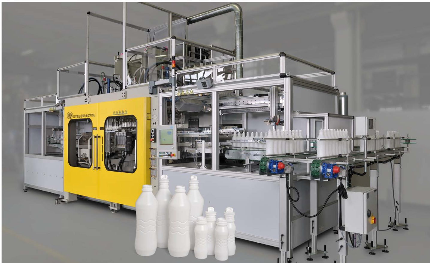
Máquina Hyblow 607DL para la producción de nueve veces de envases para 1000 ml
